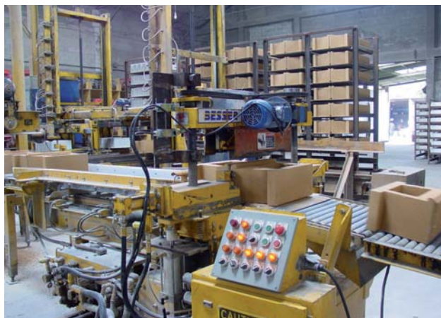
Figura 2.- Vista del proceso industrial de fabricación de las piezas de mampostería de hormigón.
